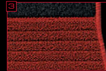
運転席側、助手席側に耐久性の高いヒールパッドを採用。靴底が滑りにくい特殊形状としている。
