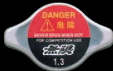
ラジエター内の圧力を高めることにより、冷却水の沸点を上げ、冷却効率を高めるハイプレッシャータイプのラジエターキャップ。ノーマル1.1kgf/cm<sup>2</sup>に対し1.3kgf/cm<sup>2</sup>。スポーツ走行などの高負荷時に威力を発揮。
