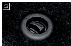
ドライバーズマットには2箇所ロックを設け、ドライビング時のズレを抑制。ロックを解除するだけで脱着が可能で清掃時の利便性を向上。
