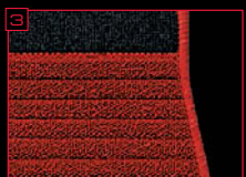
運転席側、助手席側に耐久性の高いヒールパッドを採用。靴底が滑りにくい特殊形状としている。
