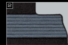
ドライバースマットに耐久性の高いヒールパッドを採用。靴底が滑りにくい特殊形状としている。
