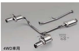
CR-V EXグレード専用設定の左右2本出しスポーツエキゾーストシステム。高い排気効率を実現すると共に、こもり音の抑制と高回転域でのスポーツエキゾーストノートを両立。CR-Vの車格にあわせフィニッシャーは二重管構造を採用。フィニッシャーはφ101.6。フィニッシャー部パイプ径はφ60.5のストレートタイプ。オールステンレス製。保安基準適合の交換用マフラー事前認証制度認定品。
