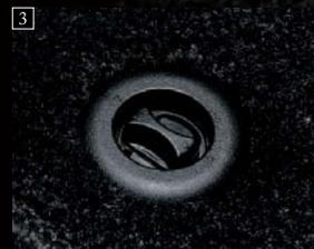
フロント・リア左右それぞれのマットに2箇所ロックを設け、ドライビング時のズレを抑止。ロックを解除するだけで脱着が可能で清掃時の利便性を向上。
