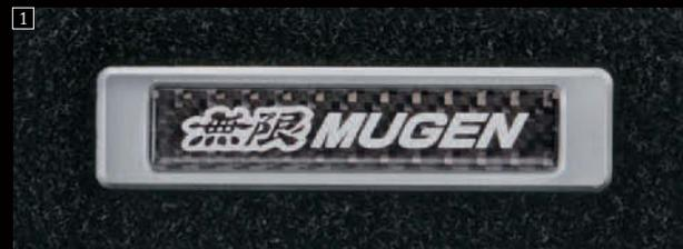
アルミニウムベースにカーボン素材を装着した専用無限エンブレムをフロント・リア左右それぞれのマットとスポーツラゲッジマットにレイアウト。
