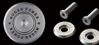
高品位切削加工で製作するナンバープレートボルト。ステンレス製のヘッド（ワッシャカラー）とボルトで構成、ヘキサゴンボルトを採用し盗難抑制にも寄与。ヘッドサイズはφ20 t=3mmで、"MUGEN POWER"をレーザー印字。2本セット。字光式ナンバープレートには装着できません。
