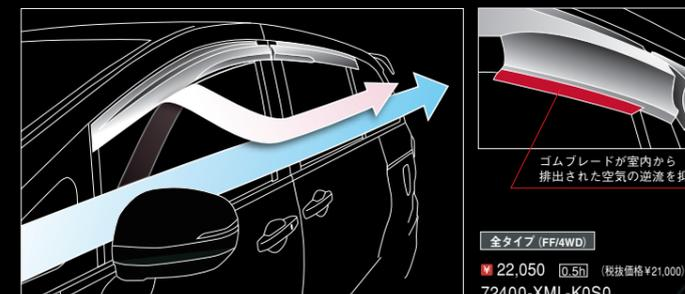
ゴムブレードが室内から排出された空気の逆流を抑制。
