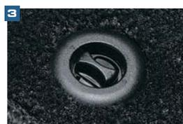
ドライバースマットには2箇所ロックを設け、ドライビング時のスレを抑止。ロックを解除するだけで脱着が可能で清掃時の利便性を向上。
