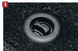
ドライバーズマットには2箇所ロックを設け、ドライビング時のスレを抑制。ロックを解除するだけで脱着が可能で清掃時の利便性を向上。
