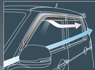
ゴムブレードが室内から排出された空気の逆流を抑制します。
