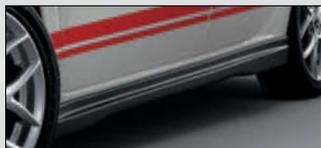
ボディサイド下部に装着するサイドロアスポイラー。真空成型のAES製。左右セット。
