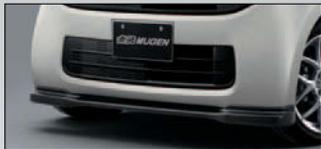
標準装備フロントバンパー下部に装着するフロントロアスポイラー。真空成型のAES製。
