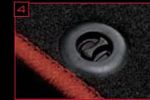
運転席側には2箇所ロックを設け、ドライビング時のズレを抑制。ロックを解除するだけで脱着が可能で清掃時の利便性を向上。
