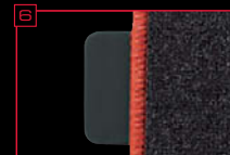
フロントマット左右の爪を内装下に滑り込ませることにより、マットの浮きを防止。乗降時の安全性にも寄与。
