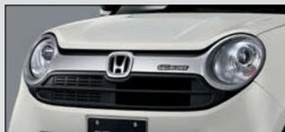
シルバーとツヤ消しブラックの2トーン仕上げのフロントスポーツグリル。標準装備フロントグリルを取り外して装着。無限フロントエアロバンパーと標準装備フロントバンパーのどちらとも同時装着可能。無限エンブレム付属。真空成型のPPE製。
