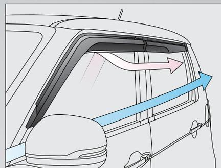
ゴムブレードが室内から排出された空気の逆流を抑制します。
