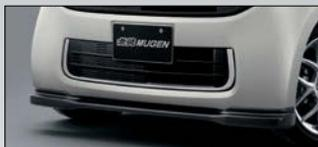
標準装備フロントバンパー下部に装着するフロントロアスポイラー。カラーはツヤ消しブラック。真空成型のAES製。
