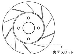
摩擦量と制動力のバランス点を探り、スリットの本数、幅、深さ、角度、形状は、徹底的なテストにより決定された。また、スリットの位置も表と裏で違えることで不快なブレーキチャタ(振動)の発生を抑えるものとしている。
