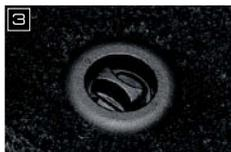
ドライバーズマットには2箇所ロックを設け、ドライビング時のズレを抑制。ロックを解除するだけで脱着が可能で清掃時の利便性を向上。
