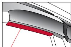
ゴムブレードが室内から排出された空気の逆流を抑止。
