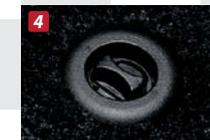
ドライバースマットには2箇所ロックを設け、ドライビング時のズレを抑制。ロックを解除するだけで脱着が可能で清掃時の利便性を向上。
