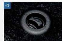
ドライバーズマットには2箇所ロックを設け、ドライビング時のスレを抑止。ロックを解除するだけで脱着が可能で清掃時の利便性を向上。
